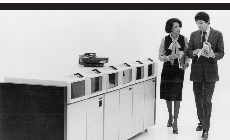
L'IBM 3340 a été introduit en mars 1973 avec des disques durs interchangeables sous la forme de «cartouches».
